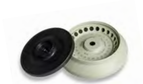
Max. kapasite: 24 x 1,5 / 2,0 ml Sipariş Numarası: 221.59 V02 Hermetik sızdırmaz
